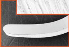
Borde corte de la cureta Sharp Diamond y ampliación del borde tras la prueba.
