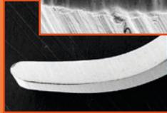
Borde de corte de una cureta sin revestimiento típica y ampliación del borde tras la prueba.
